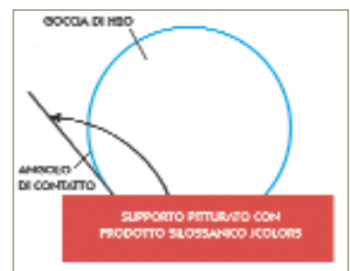
L'acqua non riesce a penetrare nelle cavillature perchè l'effetto idrorepellente è attivo anche in profondità
