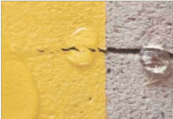
I supporti trattati con cicli silossanici possono inibire la penetrazione di acqua anche in presenza di cavillature superiori a 1 mm.
