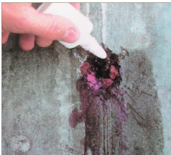
Verifica carbonatazione con Fenoftaleina
